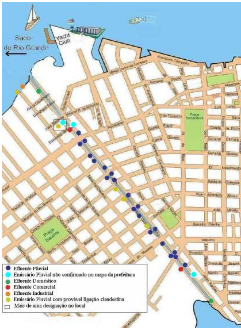
◀ Figura 3 - Identificação dos locais de lançamentos de efluentes clandestinos no canaleta (mapa adaptado de Souza, 2008).
