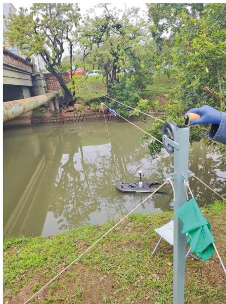
**Figura 2** – Sistema de cordas e roldanas instalado nas duas margens do arroio para guiar o equipamento de vazão.
