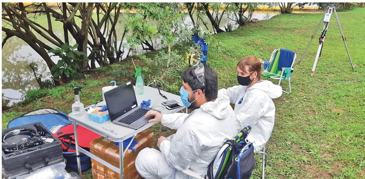
**Figura 3** – O M9 fixado a uma prancha e conectado via rádio a um notebook e a um GPS. Os sinais acústicos relativos à profundidade e à velocidade das partículas em suspensão são processados para cálculo da vazão média.
