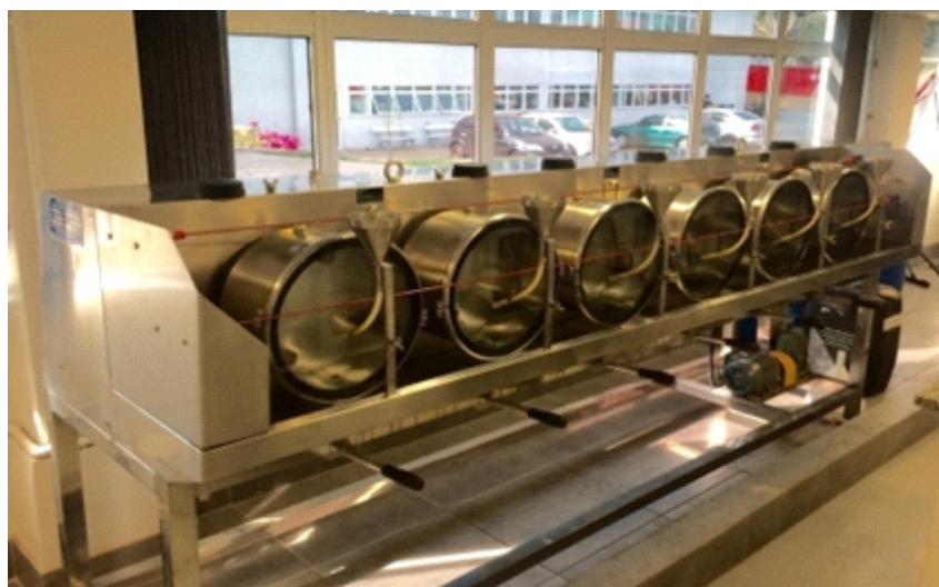
Figura 1. Conjunto de fulões para acabamento molhado em escala piloto.
